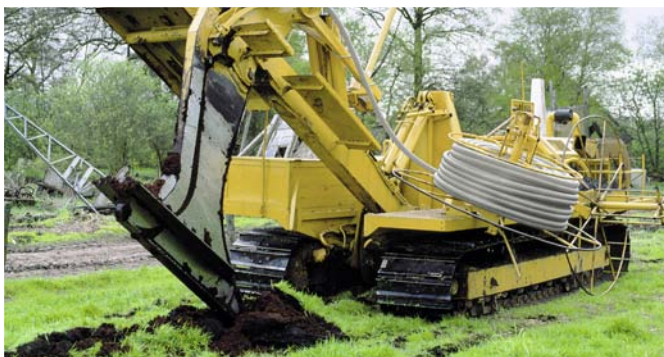
Sl. 36 Postupak polaganja bez kopanja kanala
