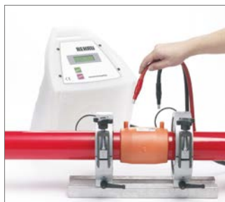
Abb. 104 Ein akustisches Signal ertönt nach Abschluss des Schweißvorganges. Im Display erscheint „OK“. Die Stecker können entfernt werden.
