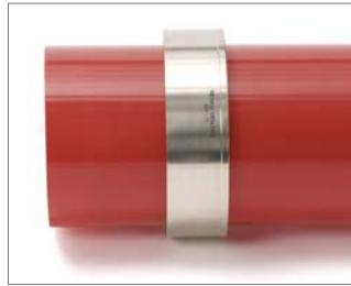
Abb. 27 2. Schiebehülse über das Rohr schieben. Innere Anfasung muss zum Rohrende zeigen.
