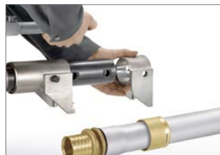
Abb. 22 6. Joche auf den Zylinder stecken.
