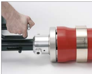
Abb. 29 4. Die Einsteckzeit des Fittings in das Rohr kann durch das Halten des Aufwiederdruckes bei voll geöffnetem Aufweitkopf (Endposition beim Aufweitvorgang) beeinflusst werden.
