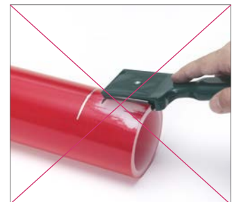
Abb. 124 Rohre nicht mit Handschaber schälen, diesen nur zur Nacharbeit verwenden. Immer Rohrschäler einsetzen (siehe Preisliste).
