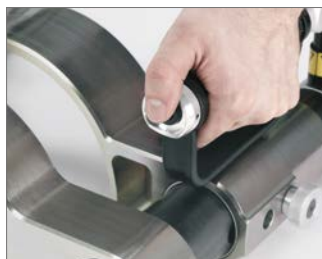
Abb. 34 9. Durch Betätigen des Druckschalters am Master-Zylinder Schiebehülse bis zum Fittingkragen aufschieben. Gegebenenfalls Steckstiftpositionen am beweglichen Joch verändern, um Schiebehülse komplett aufzuschieben. Verbindung ist sofort nach Fertigstellung mit Druck und Temperatur belastbar.
