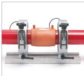
Abb. 99 Zweites Rohrende vorbereiten, in Elektroschweißmuffe vollständig einschieben und mit Rohrhalteklemmen fixieren.
