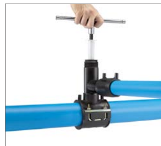
Abb. 62 10. Nach Durchbruch der Leitung das Locheisen gegen den Uhrzeigersinn bis zum Anschlag zurückschrauben.
