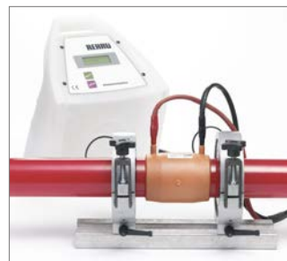
Abb. 102 Ausrichtung (=Spannungsfreiheit) und Einstecktiefe überprüfen.
