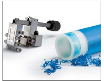
Abb. 68 Wenn Abschälgerät eingesetzt wird, nur einmal schälen. Reste der Ummantelung auf dem Rohr stören den Schweißablauf nicht, sofern die oberste Schicht (Oxidschicht) entfernt wurde.
