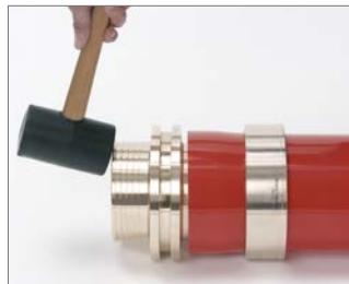
Abb. 31 6. Es muss ein gleichmäßiger Spalt zwischen Fittingkragen und Rohrende sein. Wenn nötig, muss die Position unmittelbar nach dem Einstecken mittels Gummihammer ausgerichtet werden.
