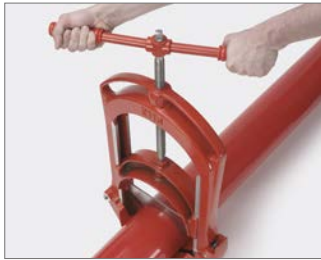
Abb. 25 1. Rohr auf das gewünschte Maß rechtwinklig mittels Guillotine ablängen...
