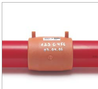
Abb. 108 Persönliche Identifikationsnummer sowie aktuelles Datum auf der Elektroschweißmuffe mit Markierungsstift vermerken.
