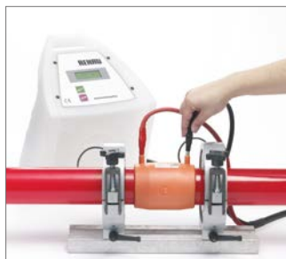
Abb. 100 Schweißgerät von REHAU anschließen, rotes Kabel auf roten Kontakt. Schweißparameter werden automatisch erkannt.
