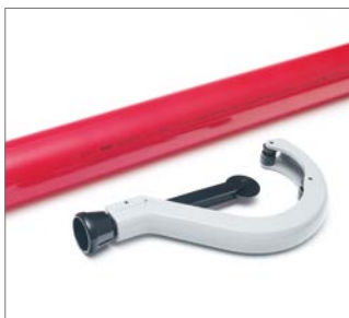
Abb. 89 Gewünschtes Maß ablängen. Schnittfläche muss gerade, rechtwinklig zur Rohrachse und gratfrei sein.
