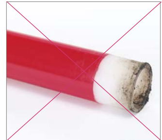
Abb. 120 Schweißzone darf weder nass noch verschmutzt sein.
