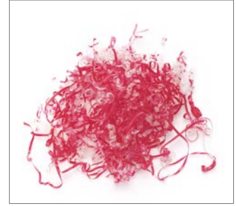
Abb. 112 Beim Abschälen sollte ein langer und gleichmäßig dicker Span entstehen (0,1 bis 0,2 mm); evtl. Rotationsschäler und/oder Messer wechseln.
