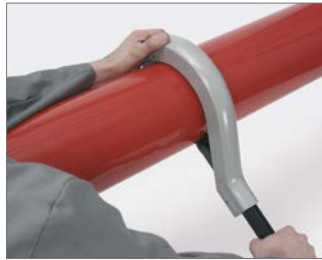
Abb. 26 ... alternativ kann auch der Rollenrohrabschneider eingesetzt werden.
