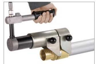
Abb. 24 8. Schiebehülse bis zum Fittingkragen aufschieben. Verbindung ist sofort nach Fertigstellung mit Druck und Temperatur belastbar.
