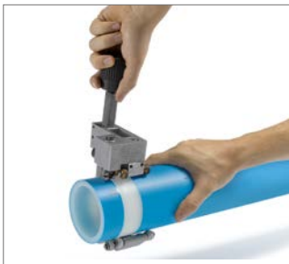
Abb. 42 4. Bei Verwendung eines Abschälgerätes kann auf das Anzeichnen verzichtet werden. Dabei darf nur einmal geschält werden!
