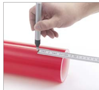
Abb. 91 Abschabbereich gemäß folgender Tabelle anzeichnen. Stift in Kontrastfarbe verwenden.
