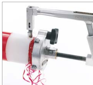
Abb. 93 Rohre zweimal schälen.
