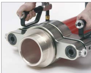
Abb. 33 8. Verpresswerkzeug RAUTOOL G1 125-160 vollständig ansetzen. Werkzeug nicht verkanten! Werkzeug muss vollflächig und im rechten Winkel angesetzt werden.
