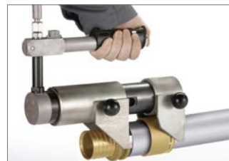
Abb. 23 7. Werkzeug an der Verbindung ansetzen. Werkzeug nicht verkanten! Werkzeug muss vollflächig und im rechten Winkel angesetzt werden.
