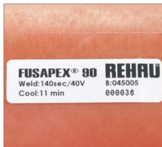
Abb. 105 Während der am Fitting angegebenen Abkühlzeit „Cool: ... min“ darf die Verbindung nicht mechanisch belastet werden.
