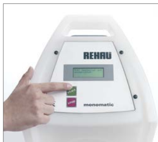
Abb. 103 Nochmaliges Drücken des Startknopfes löst den Schweißvorgang aus.
