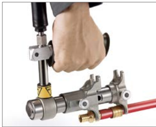
Abb. 15 5. Werkzeug an der Verbindung ansetzen. Werkzeug nicht verkanten! Werkzeug muss vollflächig und im rechten Winkel angesetzt werden.
