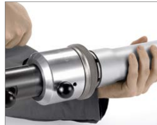
Abb. 19 3. Rohr zweimal um 30° versetzt mit Aufweiteinheit des RAUTOOL G1 aufweiten. Aufweitwerkzeug grundsätzlich bis zum Anschlag einstecken und nicht verkanten. Schiebehülse darf sich nicht in der Aufweitzone befinden.
