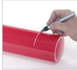
Abb. 111 Zum Anzeichnen Stift in Kontrastfarbe zum Rohr verwenden.
