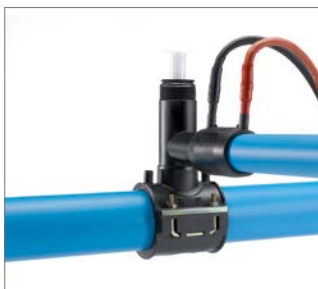
Abb. 60 8. Nach 20 Minuten Abkühlzeit Rohrleitung des Abzweiges fertigstellen. Dann den gesamten Rohrleitungsstrang am Abzweig einer Druckprobe unterziehen.
