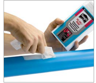
Abb. 55 3. Abschabbereich muss staub- und fettfrei sein. Mit ausreichend Tangit-Reiniger säubern und komplett verdunsten lassen.
