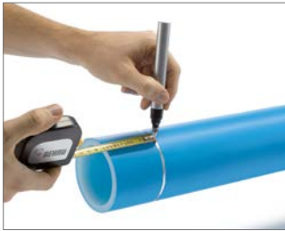
Abb. 65 Zum Anzeichnen PE-Stift in Kontrastfarbe verwenden.
