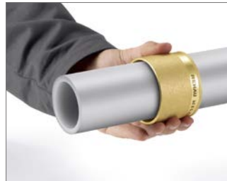
Abb. 18 2. Schiebehülse über das Rohr schieben. Innere Anfasung muss zum Rohrende zeigen.
