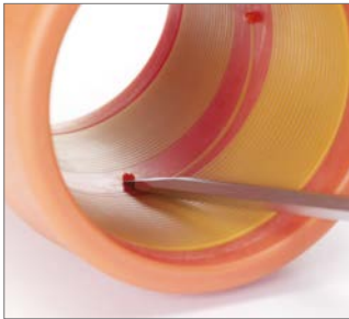
Abb. 113 Falls Muffe als Überschiebmuffe eingesetzt werden soll, sind die Anschlagrippel zu entfernen.
