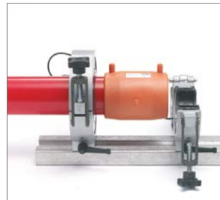
Abb. 98 Universalrohrhalteklemmen möglichst dicht an der Elektroschweißmuffe FUSAPEX montieren.
