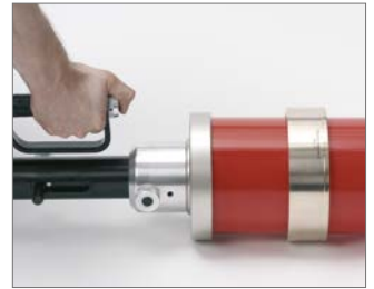
Abb. 28 3. Rohr zweimal um 30° versetzt aufweiten. Aufweitwerkzeug grundsätzlich bis zum Anschlag einstecken und nicht verkanten. Schiebehülse darf sich nicht in der Aufweitzzone befinden.
