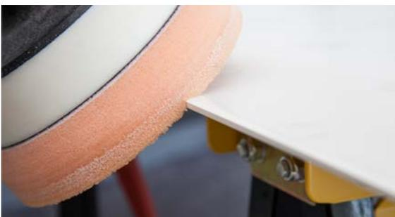
Una lucidatrice rotorbitale e un processo di lucidatura 1 step sono ideali per una finitura extra lucida. In alternativa alla lucidatrice, è possibile eseguire l'operazione a mano con un feltro lucidante.
