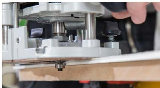
Durante la fresatura di un bordo smussato, verificare che le dimensioni del bordo non superino lo spessore dello strato trasparente. Uno spessore di 1,5 mm garantisce un aspetto estetico ottimale. Per realizzare un bordo smussato, utilizzare una fresa a 45°.
