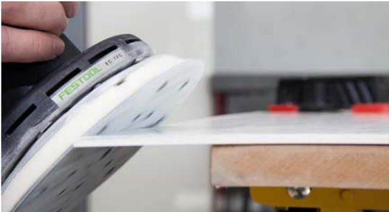
Mit einem Exzenter-Schleifer und feinem Schleifpapier lassen sich die bearbeiteten Kanten von RAUVISIO crystal slim weiter veredeln. Achten Sie dabei auf folgende Punkte:
