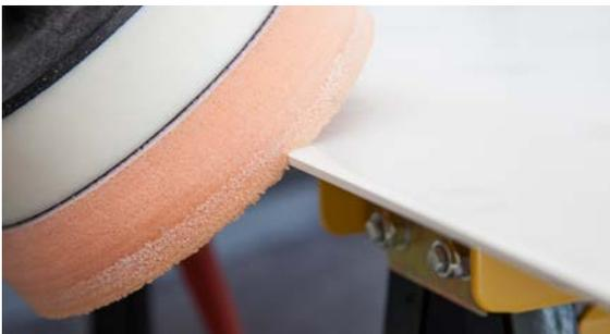
Mit einem Rotationspolierer und der Verwendung einer 1-Step Politur können Sie ein hochglänzendes Ergebnis erzielen. Alternativ zur Poliermaschine kann der Vorgang händisch mit einem Polierfilz durchgeführt werden.
