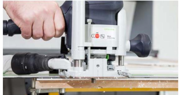
RAUVISIO crystal slim lässt sich mit Oberfräse und Führungsschiene auf das gewünschte Maß formtieren. Bei der Bearbeitung mit der Oberfräse beachten Sie bitte:
