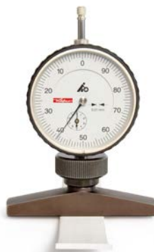
Messen der größten Vorspannung
