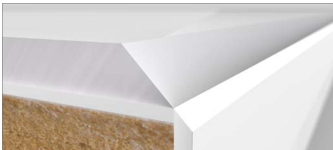
Fig. 11-20 Șanfrenare la 45° pe cant și pe suprafață
