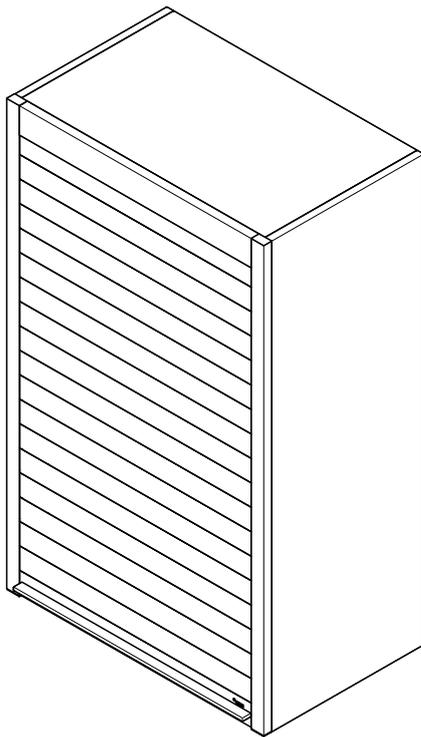
Sicherheitshinweis! Gemäß DIN EN 14749 muss die Jalousie nach der Endmontage so eingestellt sein, dass diese sich bei geöffnetem Zustand ab 200mm von der Schrankunterkante aus gemessen, nicht selbsttätig bewegt! Der Schrankhersteller ist verpflichtet, den genannten Hinweis an Weiterverarbeiter, Monteur und Endkunden weiterzugeben.
