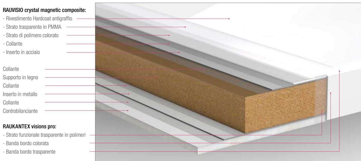
Fig. 4-1 Sistema integrato RAUVISIO crystal magnetic composite
