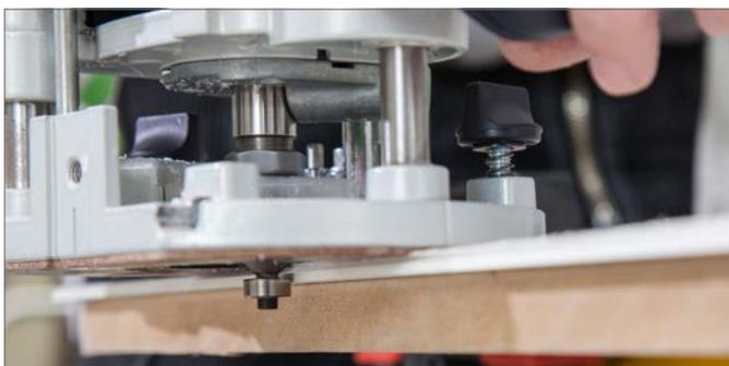
Durante la fresatura di un bordo smussato, verificare che le dimensioni del bordo non superino lo spessore dello strato trasparente. Uno spessore di 1,5 mm garantisce un aspetto estetico ottimale. Per realizzare un bordo smussato, utilizzare una fresa a 45°.
