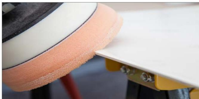
Una lucidatrice rotorbitale e un processo di lucidatura 1 step sono ideali per una finitura extra lucida. In alternativa alla lucidatrice, è possibile eseguire l'operazione a mano con un feltro lucidante.
