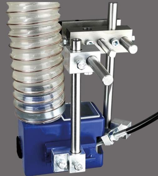
Die **Auftragseinheit** ist kompakt konstruiert und kann so oftmals, trotz der meist engen Platzverhältnisse innerhalb von Kantenbearbeitungsmaschinen, nachgerüstet werden.
