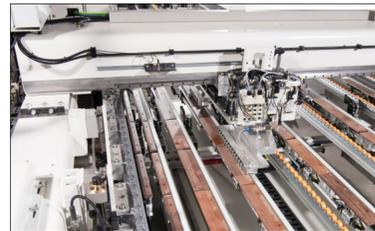
Servo-Einschub- und Anschlagssystem
