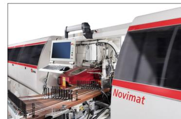
Laserstation mit 12-fach Kantenmagazin
