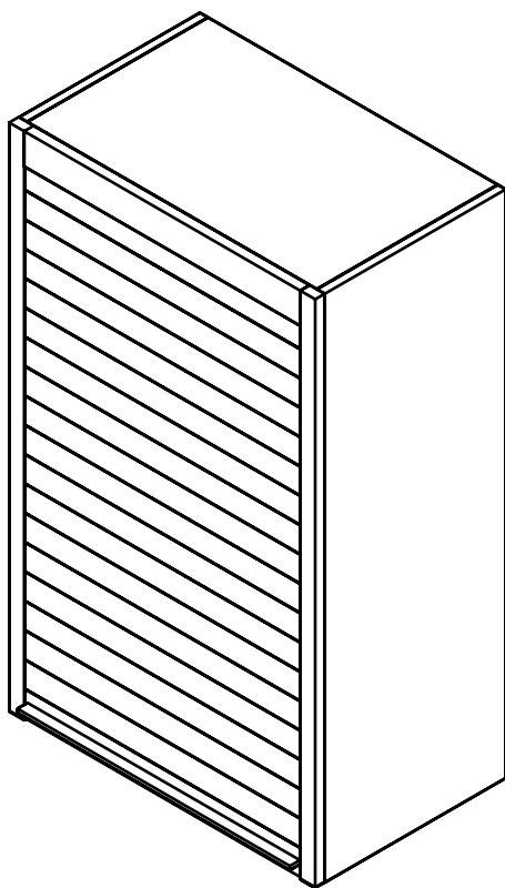
Sicherheitshinweis! Gemäß DIN EN 14749 muss die Jalousie nach der Endmontage so eingestellt sein, dass diese sich bei geöffnetem Zustand ab 200 mm von der Schrankunterkante aus gemessen, nicht selbstdäig bewegt! Der Schrankhersteller ist verpflichtet, den genannten Hinweis an Weiterverarbeiter, Monteur und Endkunden weiterzugeben.
