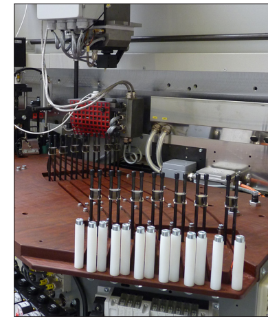
Verleimmagazin mit 6-fach Kantenmagazin
